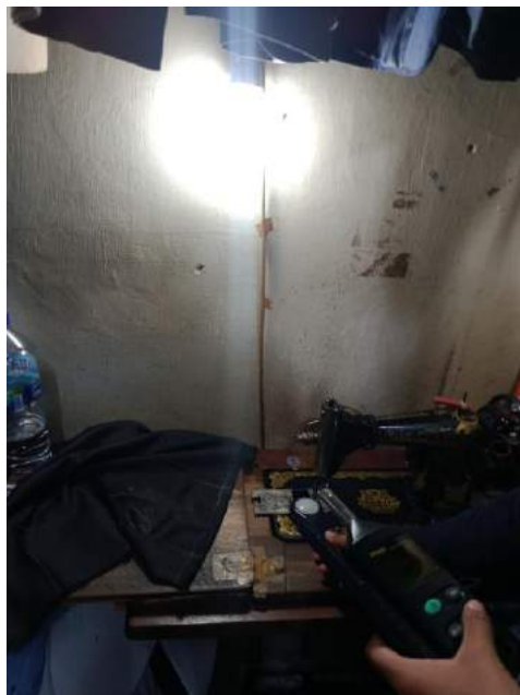
Gambar 11. Pengukuran intensitas pencahayaan di meja kerja penjahit 2
