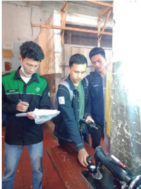
Gambar 10. Pengukuran intensitas pencahayaan di meja kerja penjahit 1
