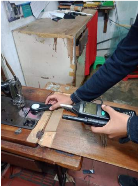
Gambar 12. Pengukuran intensitas pencahayaan di meja kerja penjahit 3
